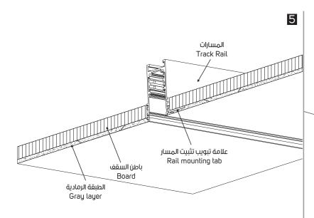
هذه الطريقة تصلح للتركيب المغروس فقط, والتركيب عن طريق التعليق لا يحتاج لهذه العملية The embedded installation type requires ash, and the surface installation and hanging wire type do not need this operation
